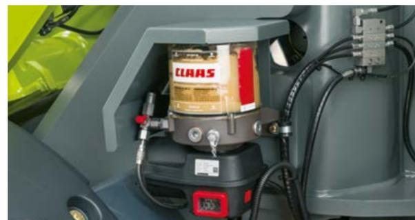
Der Vorratsbehälter der Zentralschmieranlage liegt auf der linken Maschinenseite.
