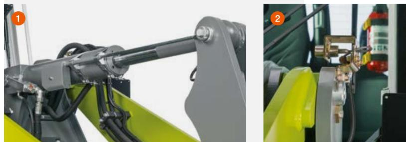
Schaufelrückführung (1) und Hubhöhenbegrenzung (2) sind für jedes Anbaugerät individuell mechanisch einstellbar.
