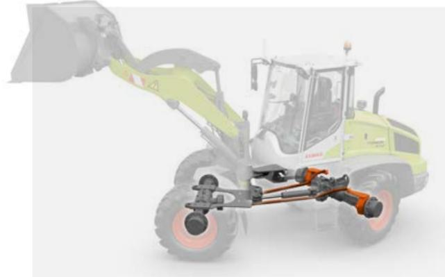
Genau dafür wurde das Fahrwerk des TORION SINUS entwickelt. Die Maschine lenkt nicht nur über das Knickpendelgelenk in der Mitte, sondern auch über die Hinterachse. Zwei Lenkstangen verbinden den Vorderwagen mit den hinteren Achsschenkeln. Sobald Sie den Radlader über das Lenkrad einknicken, lenkt die Hinterachse synchron mit.
