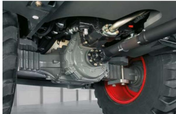
Hydrostatisches Getriebe mit selbsthemmender Bremswirkung
